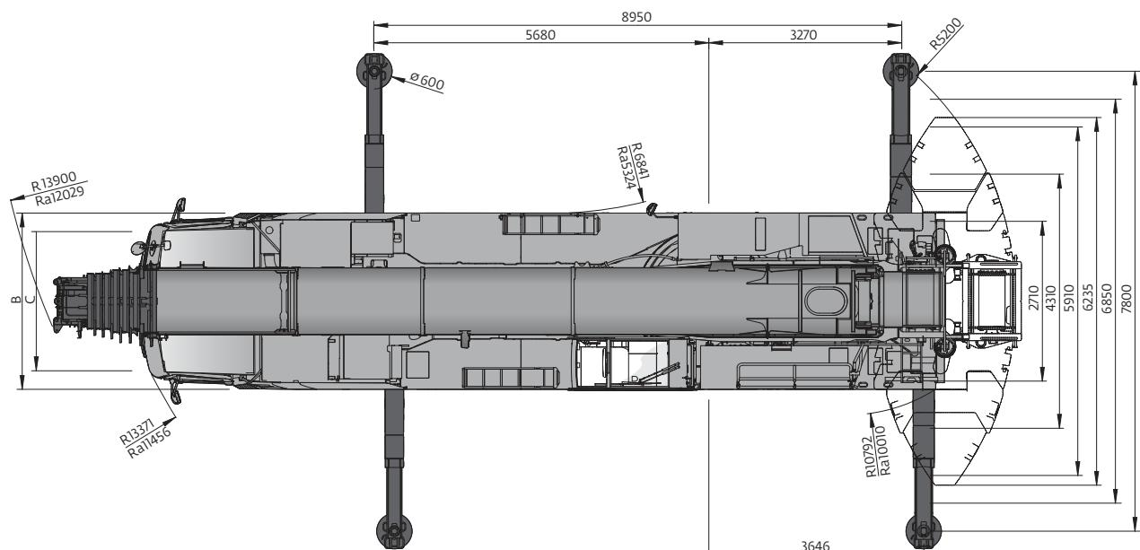
Ra = Radius all wheels steered. • Radius allradgelenkt. • Rayon toutes les roues directrices. • Radio de giro con todas las ruedas giradas. • Raggio di curva con tutte le ruote sterzate.
